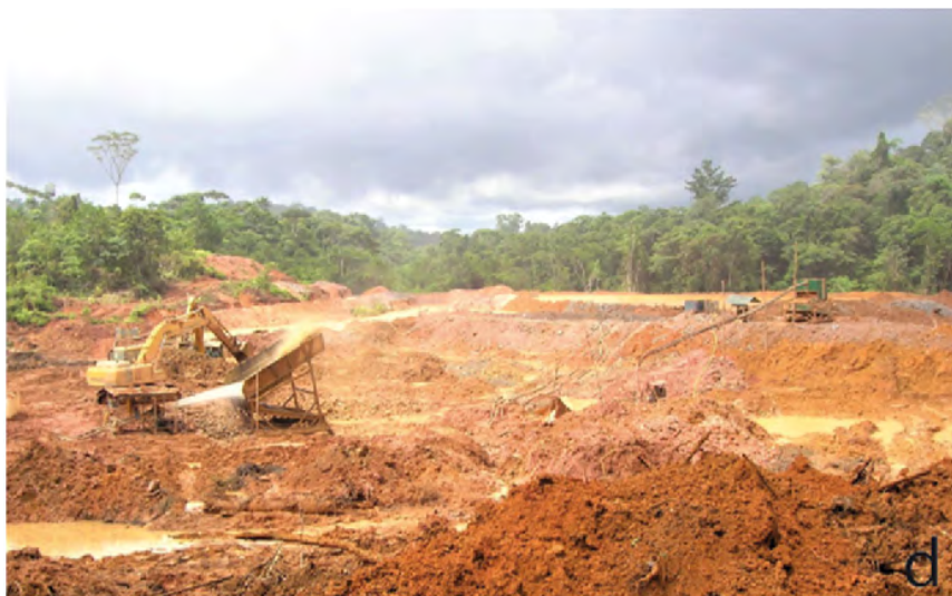
d Exploitation alluvionnaire moderne montrant une pelleteuse, une pompe à gravier, un crible à barreaux ("grizzly") et un tapis d'or (2007, crique Boulanger ; photographie P. Rostan).
