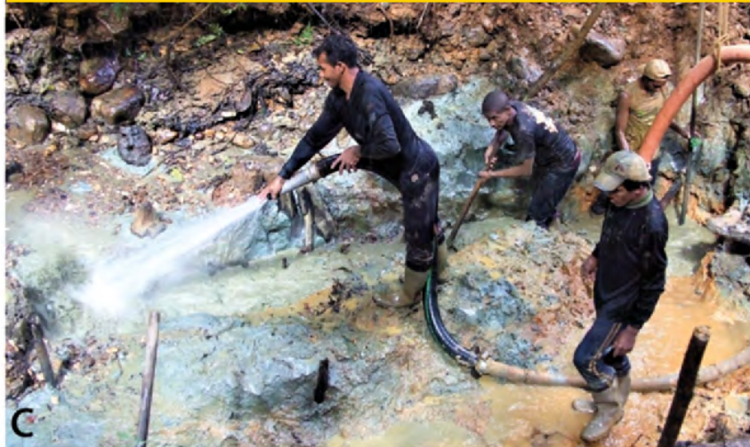
c Mineurs brésiliens illégaux travaillant des alluvions avec une lance monitor et une pompe à gravier (2008, Crique Roche, Saül, photographie P. Rostan).
