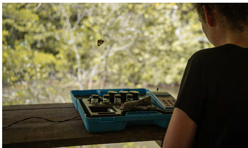
Échantillonnage de l'eau de la rivière Arataye. : mesure du pH de l'eau à l'aide d'un pH-mètre électronique et de la turbidité de l'eau. Ces prélèvements ont pour objectif l'étude hydrologique, biogéochimique et géomorphologique à grande échelle de fleuves considérés comme des sentinelles du changement climatique et des changements locaux d'utilisation des terres
