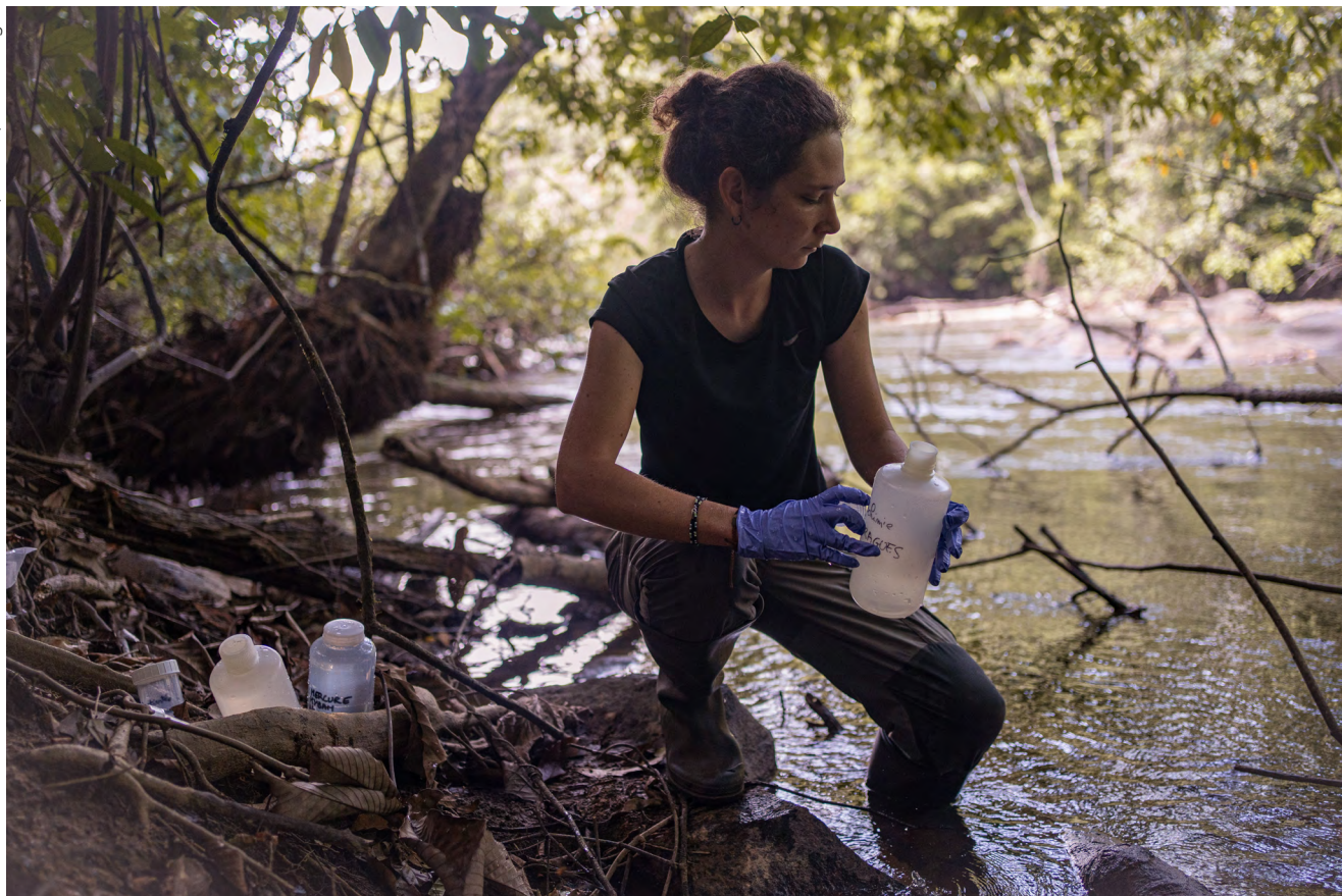
Échantillonnage de l'eau de la rivière Arataye. : mesure du pH de l'eau à l'aide d'un pH-mètre électronique et de la turbidité de l'eau. Ces prélèvements ont pour objectif l'étude hydrologique, biogéochimique et géomorphologique à grande échelle de fleuves considérés comme des sentinelles du changement climatique et des changements locaux d'utilisation des terres
